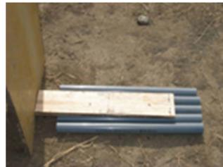
セパレータ移動防止治具及びダミーさや管(415mm)
