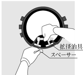
図 7-76 スペーサーの挿入
