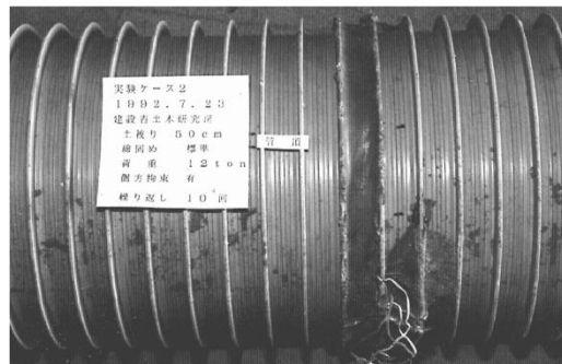
写8-3 実験ケース1 (呼び径250、土かぶり50cm、117.7kN{12トン}、繰り返し数10 4 回) 载荷後
